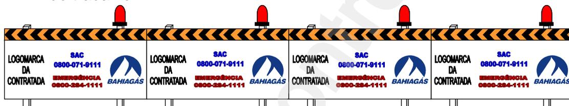
5.30.3. Isolamento com tela e sinalização noturna sem o uso de cones nesta composição todos os pontaletes devem estar equipados com a iluminação e o marcador de alinhamento alternadamente, esta composição pode ser mantida após o término do trabalho.
